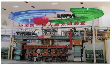
答：中国环流器一号。该装置用于磁约束受控热核聚变（人造太阳）基础研究，由中国科学院院士、著名核物理学家李正武领导研制。1984年9月21日，在乐山585所建成启用，是中国受控热核聚变研究的里程碑。该装置及原实验地址现已建成中国核聚变博物馆。
